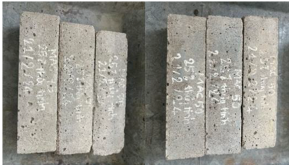
Hình 4. Các mẫu khi được nghỉ 7 ngày sau 28 ngày ngâm trong nước
